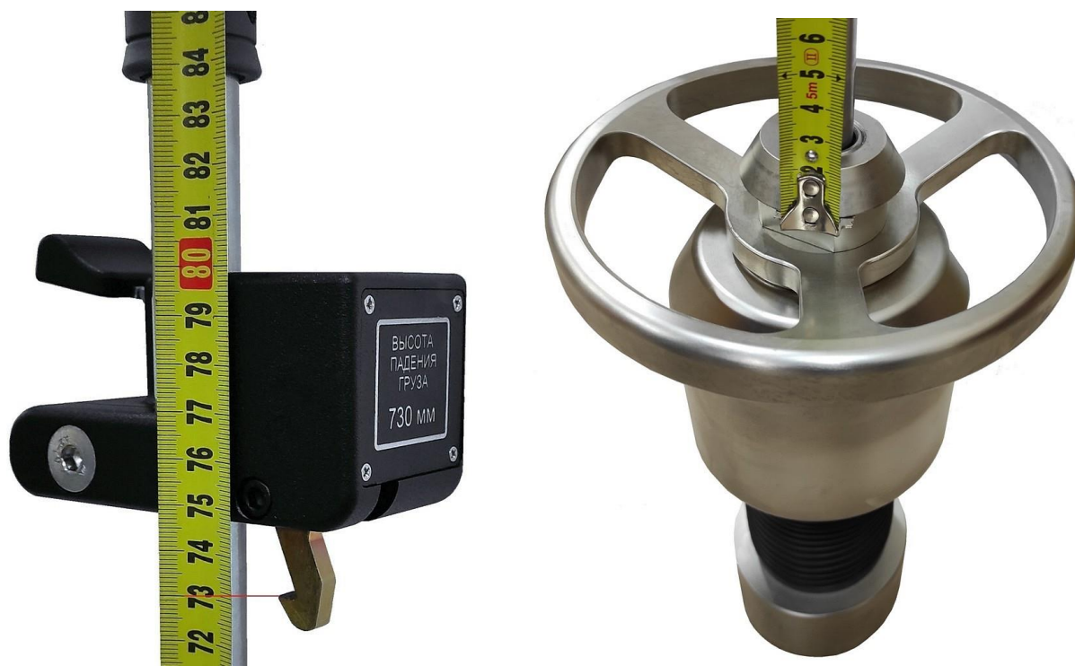
Рисунок 3 – Измерение высоты сброса груза (расстояния от крючка механизма фиксации до верхней грани груза)
